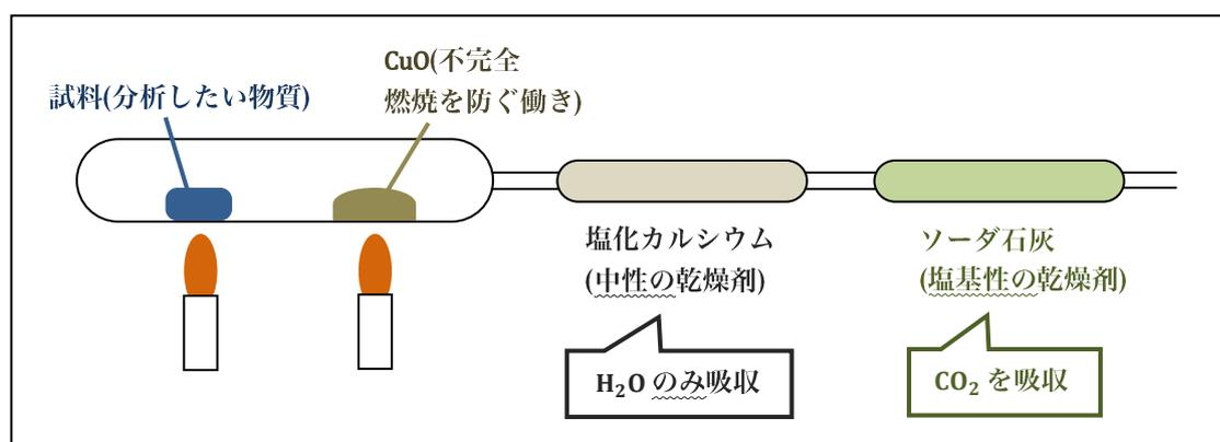
※ 塩化カルシウムとソーダ石灰の順序を逆にすると、ソーダ石灰でH<sub>2</sub>O、CO<sub>2</sub>ともに吸収されてしまい、別々の質量が分からなくなってしまう(乾燥剤については「非金属の攻略」で詳しく説明している)。
