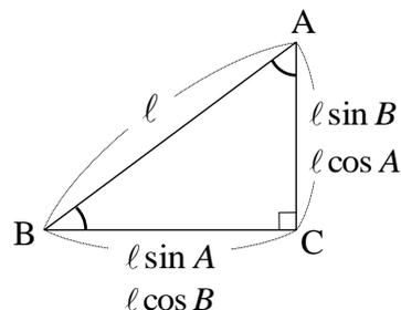
このように、 $\sin$ ,  $\cos$  の記号を使うと、角の大きさを辺の比を用いて表したり、辺の長さを角を用いて表せます。
