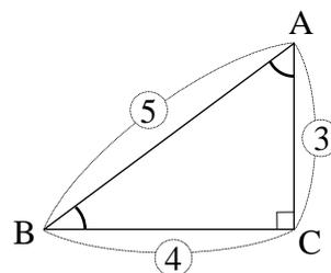
さらに、斜辺 AB の長さを  $l$  とすると、残りの 2 辺 AC と BC の長さは次のように表されます。
