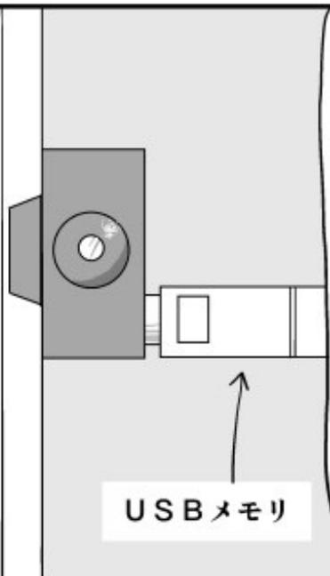
カメラユニットにはUSB端子が搭載されていて、撮影した写真はここに刺してUSBメモリに記録します。
