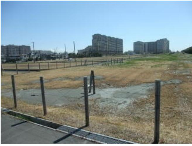
実際の液状化は、面状には発生せず、線上に発生しています。空き地などで液状化の噴出された砂をみればよくわかります。噴出されていない地域を囲むように噴出された砂がでています。非常に不均一ですが、おおむね線上になっています。公園でも同じようで、実際の住宅の下などもこんな感じなのでしょう。
