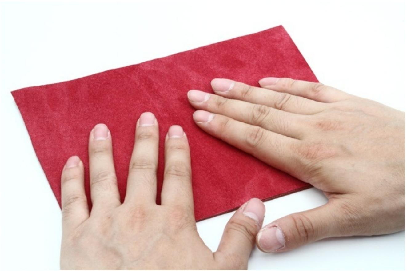
接着した面をしっかり押さえて、圧着します。圧着をしっかりすることで、接着強度が高まります。
