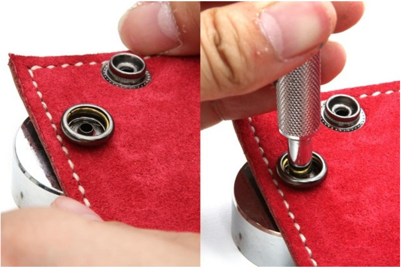
ジャンパードットの組み合わせに注意しましょう。写真左のように組み合わせて留めます。
