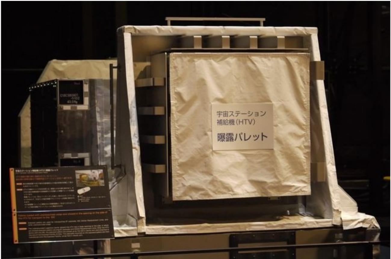
曝露パレット試験モデル
