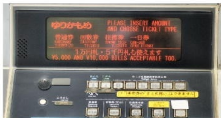
RUG512x160ドットという品種のDC型プラズマディスプレイ。ありがたい事である。
