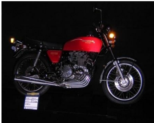
(ホンダ・CB400 4in1 OHC 16バルブ 4気筒 エンジン 408cc)
