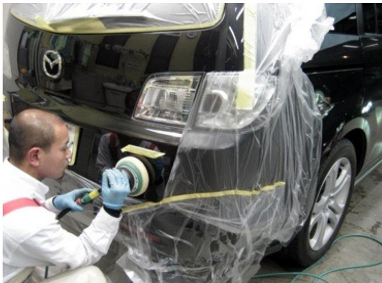
リアゲートを交換され部分的にボディコーティングを補修しています。
