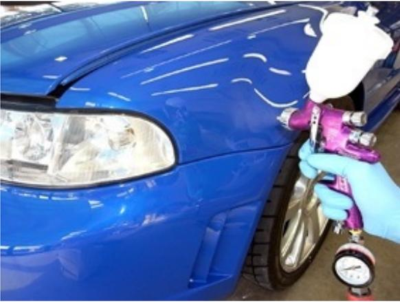
鮮やかに甦った塗装面を、専用スプレーガンでクォーツガラスコーティングFXをコーティングしていきます。
