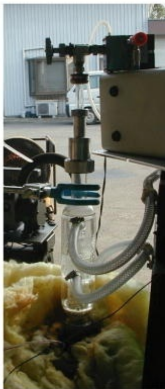
ガラス製油拡散ポンプによる オゾン化オイル製造実験
