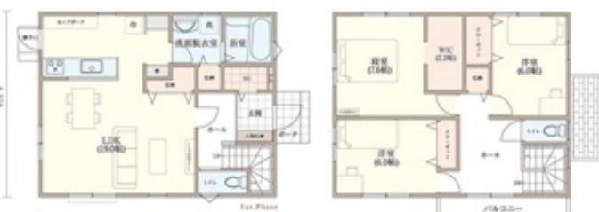
【上記[F-01-E]】 ■延床面積:104.34㎡(31.56坪) ■施工床面積:110.13㎡(33.31坪) 1階面積:52.17㎡(15.78坪)/2階面積:52.17㎡(15.78坪)/ポーチ面積:1.65㎡(0.50坪)/UVLコナ-面積:4.14㎡(1.25坪)
