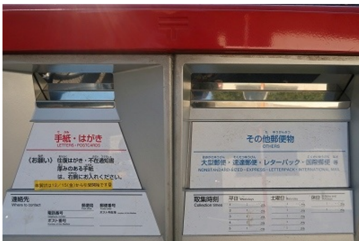
投入口は向かって左側が「手紙・はがき」、右側が「その他郵便物（大型・速達郵便など）」 郵便差出箱7号との変更点は、差入口の幅を変えています。
