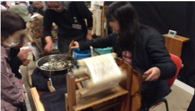
お湯の中には30個の繭が浮かび、右手で混ぜながら、左手で糸を巻いていきます。
